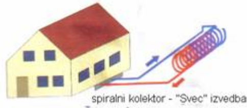
spiralni kolektor "Slinky" izvedba
